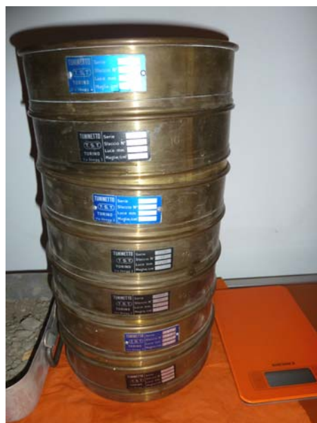
Particolare dei crivelli ASTM utilizzati e del materiale analizzato dopo essiccazione in forno.
